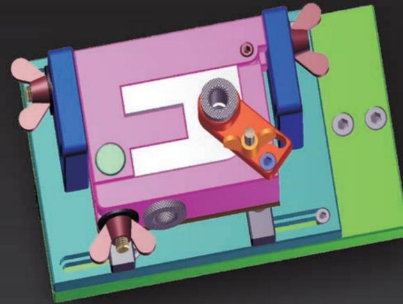
»» Bohrvorrichtung für Gelenkstück,
