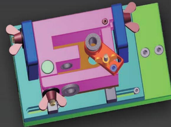
»» Bohrvorrichtung für Gelenkstück,
